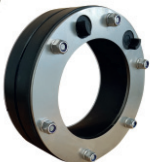
Pressio®-Rings 1 x 40 mm Gummi mit 2 x 16 mm Bohrung inkl. Einsatz und Blindstopfen
